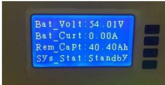
Рисунок 4 – Дисплей BMS АКБ серии RT-AB-Li-CBN
